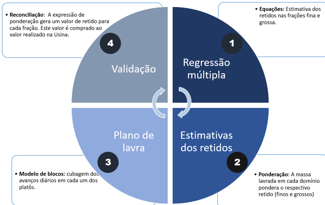
Figura 6 – Metodologia de aplicação prática do modelo geometalúrgico.
